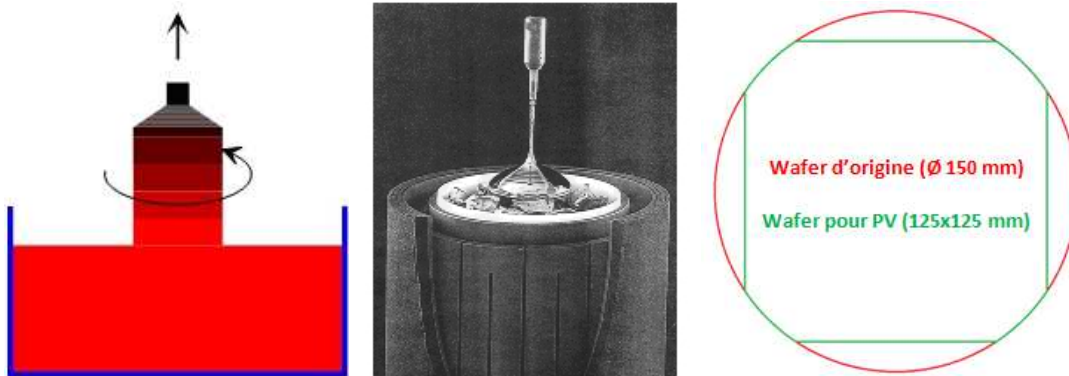
Figure 1.5 : à gauche principe de fonctionnement du tirage Czochralski, au centre une image du procédé et à droite la différence entre le wafer d'origine et celui utilisé dans le module PV.
