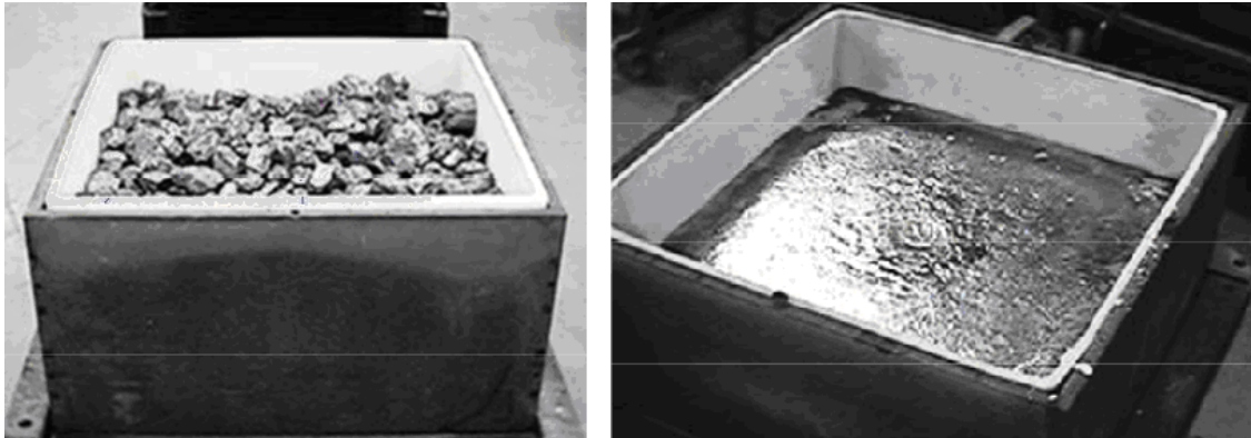
Figure 1.7 : (à gauche) un creuset en silice rempli de morceaux de silicium pour four de solidification dirigée ; (à droite) ce même creuset après cristallisation du lingot [images de Photowatt].
