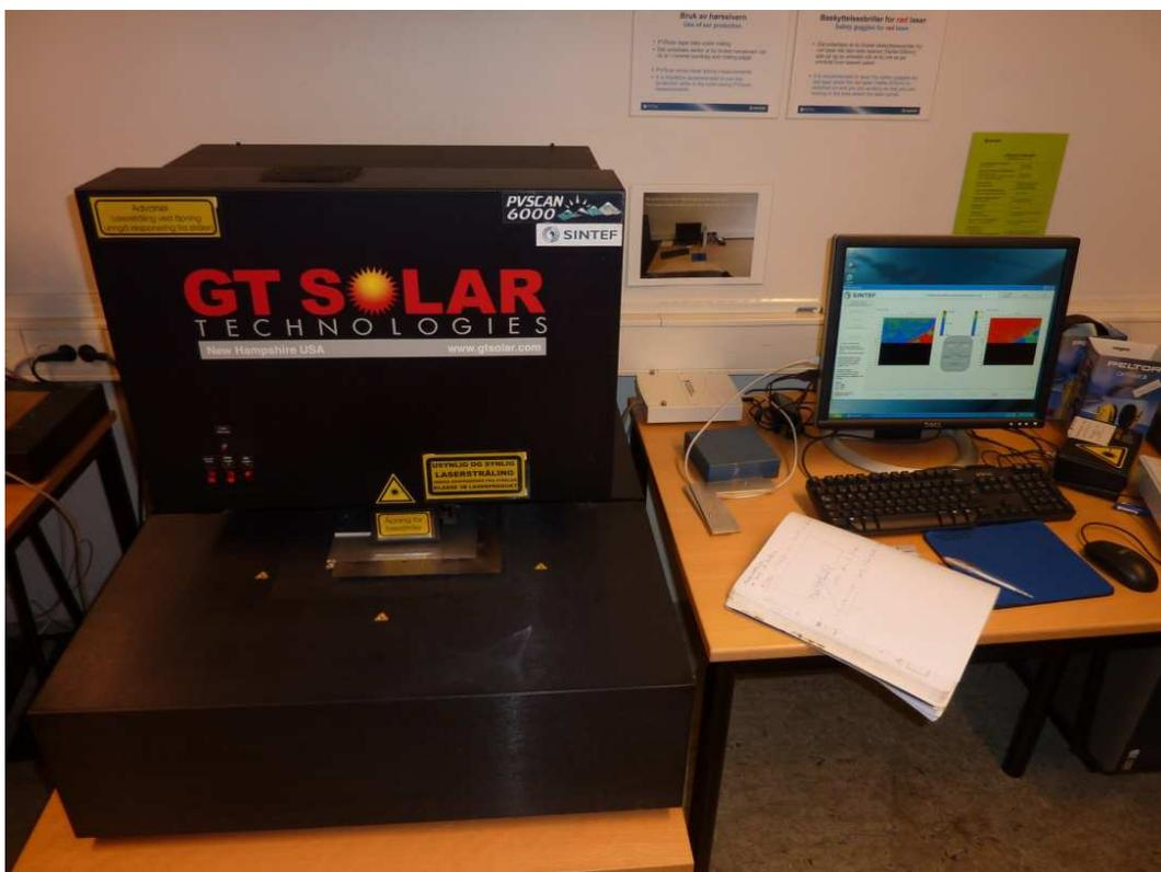
Figure 2.16 : l'instrument PVScan servant à la caractérisation.
