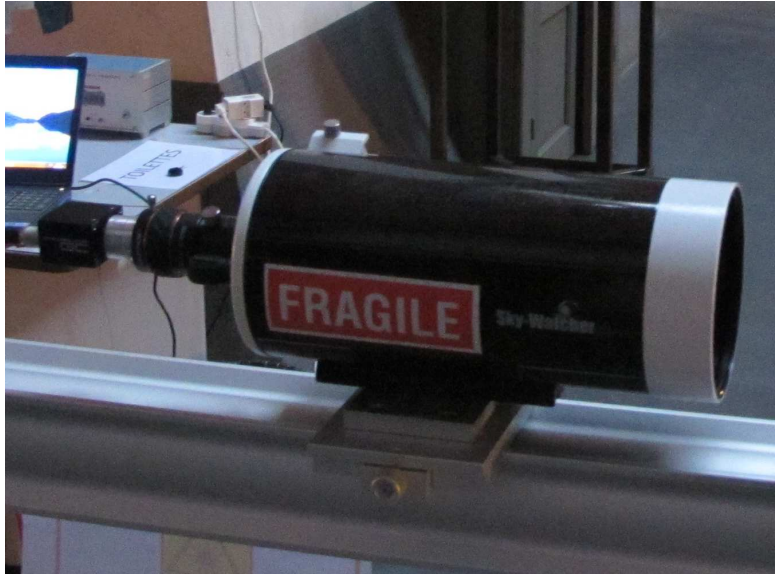
FIGURE 2.2 – Photographie du télescope et du système optique placé à son foyer. Les faisceaux traversent une lentille de Barlow avant d'être détectés par la caméra CCD.
