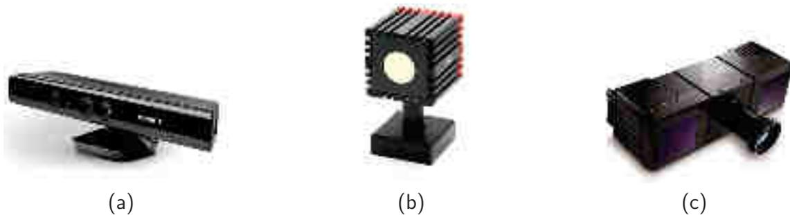
FIGURE 2.16 : Exemples de caméras 3D : (a) Kinect de Microsoft ; (b) SR-4000 de MESA Imaging ; (c) PMDCamCube3.0 de PMD Technologies GmbH
