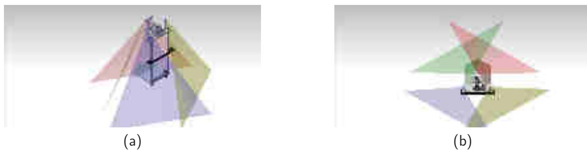
FIGURE D.2: Champs de vision des caméras à partir de la configuration
