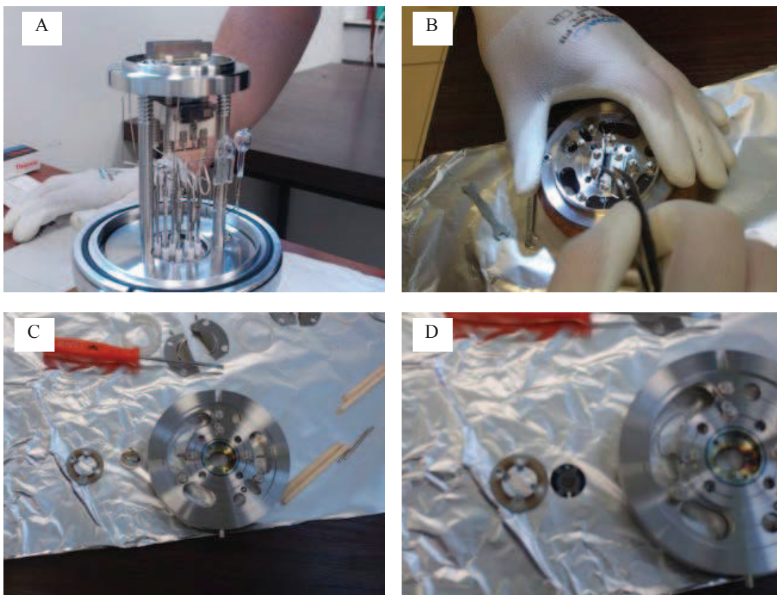
Figure 30 : Photos lors du démontage de la source (source : Blog PalHydroMil). A : Source avant démontage. B : Vue extérieure de la partie inférieure de la source. C : Vue de l'intérieur de la source avant nettoyage avec les pièces dirigeant le faisceau d'atomes. D : Pièces nécessitant un nettoyage.
