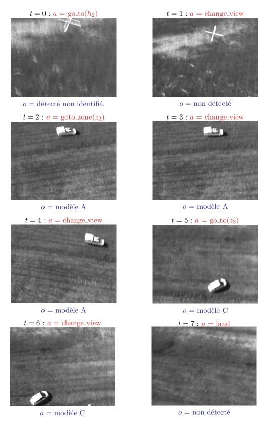
FIGURE 6.10 – Séquence d'étapes de décision. Chaque image représente l'image d'entrée reçu par l'algorithme de traitement d'image après réalisation d'action. Les observations représentent les réponses successives de la classification donnée par le traitement d'image.
