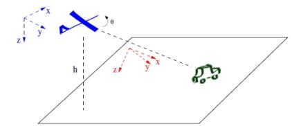
FIGURE 3.3 – Schéma de la prise de vue aérienne avec les paramètres dont l'algorithme de [Saux et Sanfourche, 2011] dépend (image issue de [Saux et Sanfourche, 2011]).
