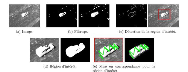
FIGURE 3.4 – Traitement d'image pour la détection et reconnaissance de cible basé sur l'algorithme de [Saux et Sanfourche, 2011].
