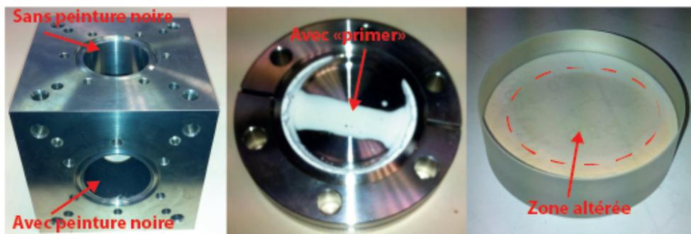
FIGURE 3.4 – Les photographies de gauche et du milieu montre les dépôts de "primer" et de peinture noire réalisés pour le test. La photographie de droite illustre l'altération observée sur les hublots après étuvage de l'enceinte avec peinture.
