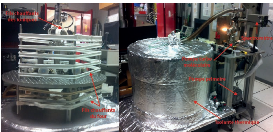
FIGURE 3.12 – Photographies du four réalisé pour l'étuvage de l'enceinte à vide.
