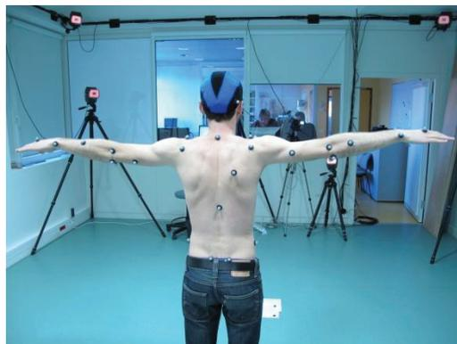
Figure 12 : Le système optoélectronique
