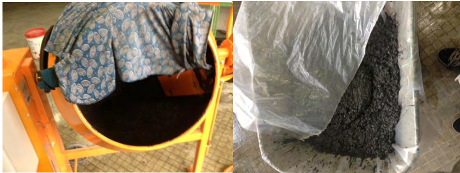
Figure III – 1 : Simulation des modes de transport du béton : en transport dynamique à gauche et statique à droite
