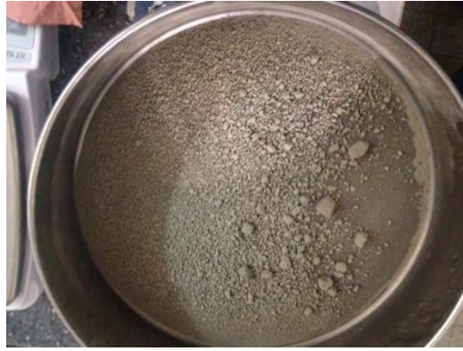
Figure II – 1 : Présence de floculats dans le ciment due à un mauvais conditionnement
