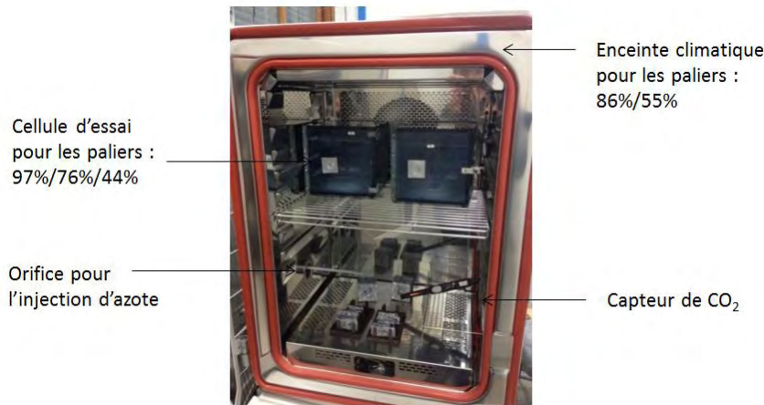
Figure V – 11 : Dispositif pour les isothermes à 20 °C
