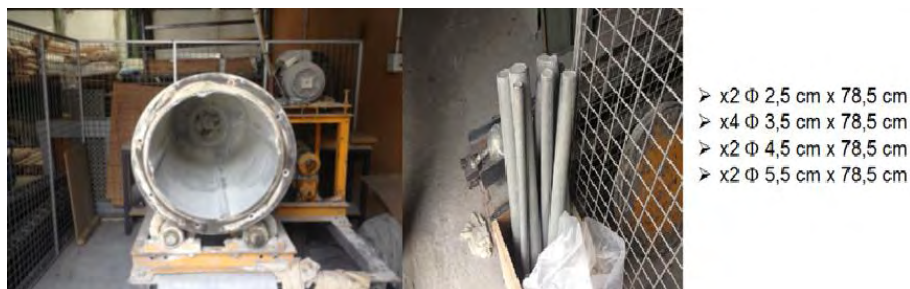
Figure II – 3 : Le broyeur à barres (à gauche) et le jeu de barres utilisées, nombre x diamètre x longueur des barres (à droite )
