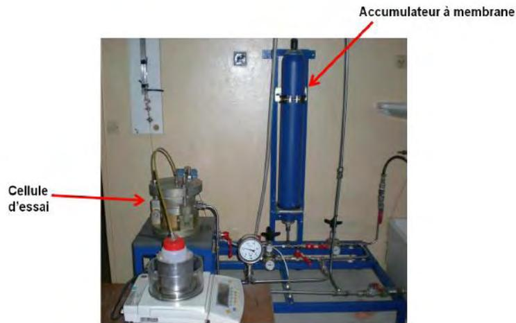
Figure V – 10 : Perméamètre au liquide développé au LMDC
