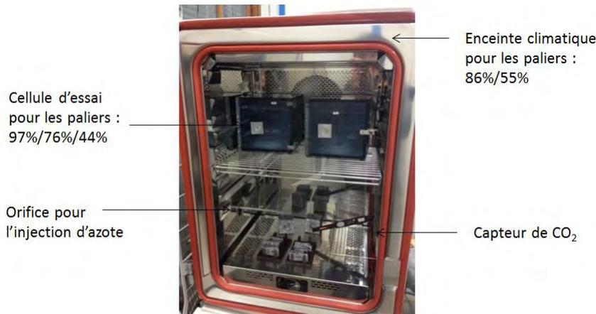
Figure V – 11 : Dispositif pour les isothermes à 20 °C
