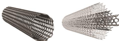
Figure II : Structure de nanotubes de carbone monofeuillet à gauche et multifeuillet à droite.
