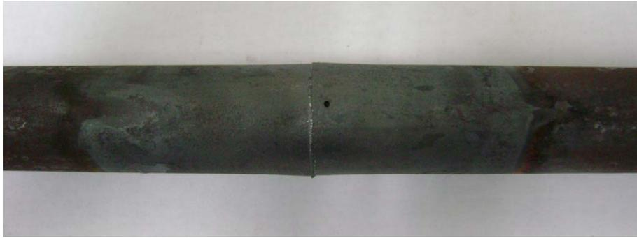
*Fig. 3.3. Barras unidas por el método TLPB. Se observa sólo una ligera deformación plástica en la junta.*
