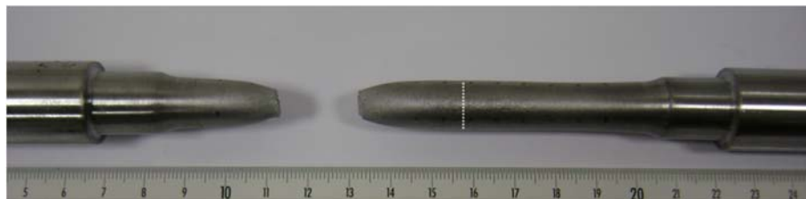
Fig. 3.5. Probeta obtenida de las barras unidas utilizando el set propuesto, luego de ser ensayada a tracción. Se destaca la fractura dúctil fuera de la junta, la cual se marca con línea de puntos blanca.
