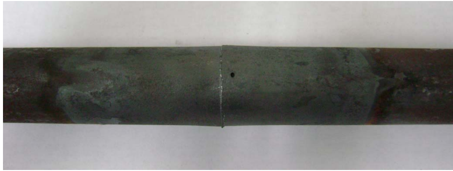
Fig. 3.3. Barras unidas por el método TLPB. Se observa sólo una ligera deformación plástica en la junta.
