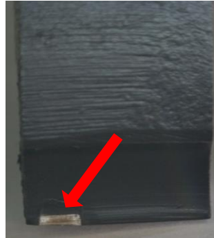
Figure III-6 : Trace laissée par le copeau sur l'outil après essai
