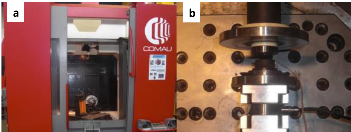
Figure II-10 : Tribomètre grande vitesse. a) Vue d'ensemble. b) Vue de dessus.
