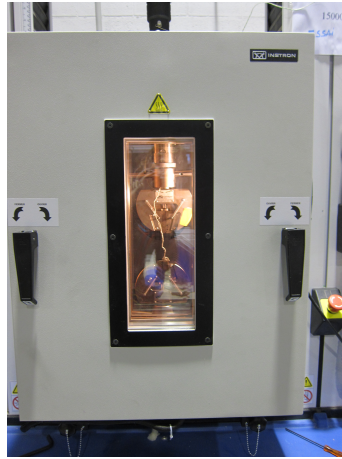
Figure B.3 – Machine hydraulique de traction quasi-statique INSTRON équipé d’une chambre thermique.
