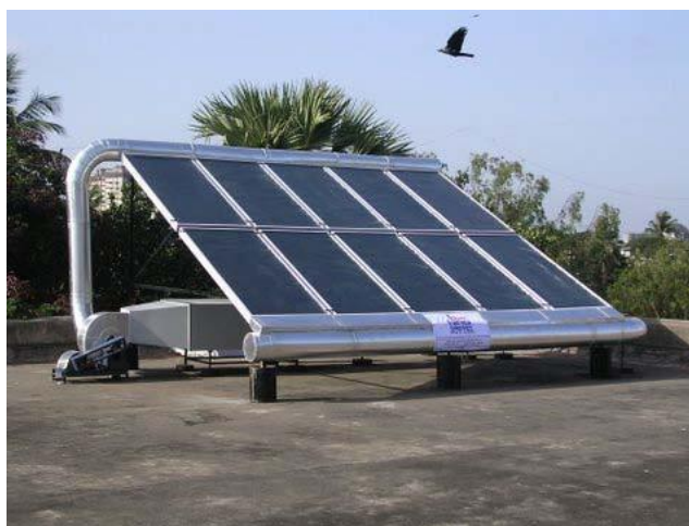
Figure 1.2 Une pilote de séchage solaire (Aware & Thorat, 2012)
