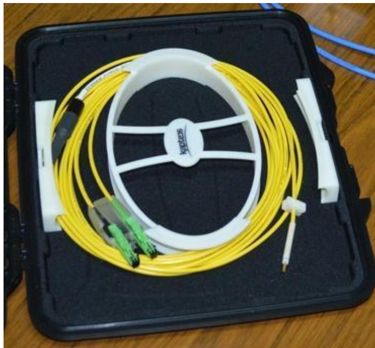
Figure III-76 Capteur dipolaire passif
