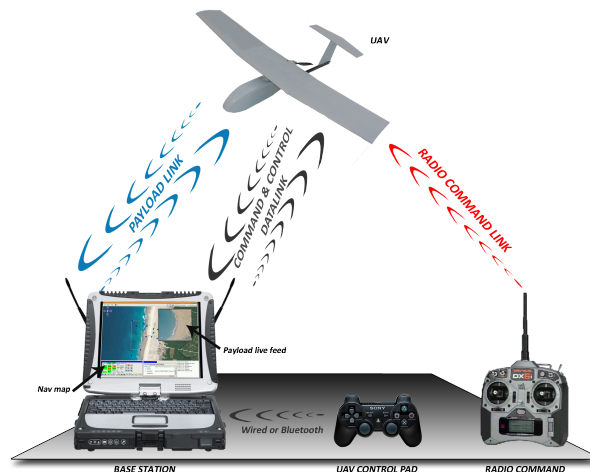
Figure 2.4 – Schéma d'un système drone (source : Fly-n-Sense)
