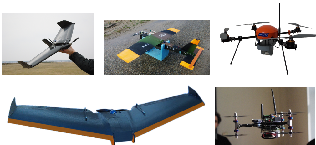
Figure 2.5 – Quelques exemples de mini-drones à voilure fixe (à gauche) et tournante (à droite) équipés par Fly-n-Sense
