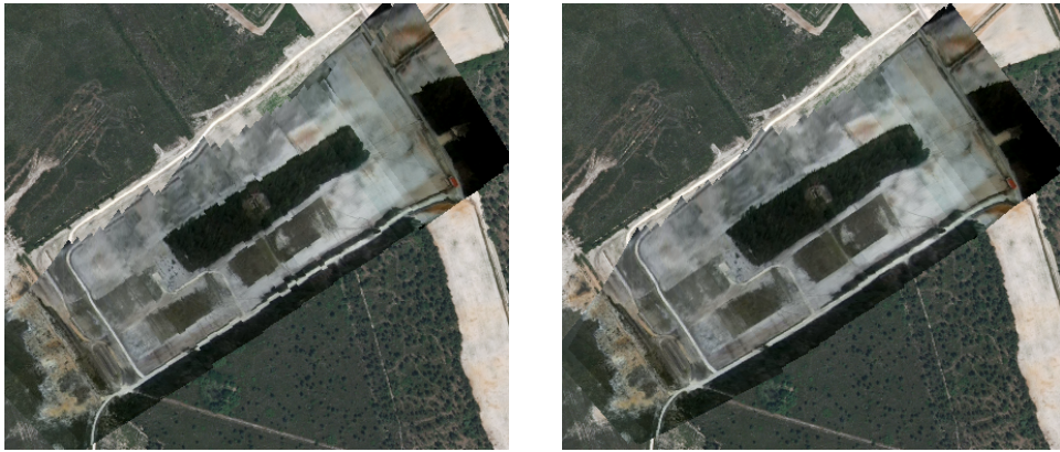
Figure 5.7 – Mosaïque utilisant uniquement les mesures de télémétrie (gauche) et avec optimisation globale (droite)
