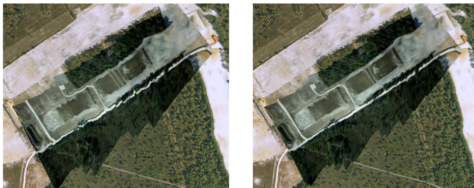
Figure 5.8 – Mosaïque utilisant uniquement les mesures de télémétrie (gauche) et avec le filtre complémentaire (droite)
