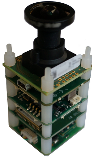
Figure 3.4 – Système d’acquisition vidéo et inertiel développé
