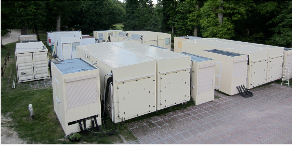
Fig. 16 : Plateforme de l'écotron composée de plusieurs ecolab, chaque ecolab est composé de 3 cellules.
