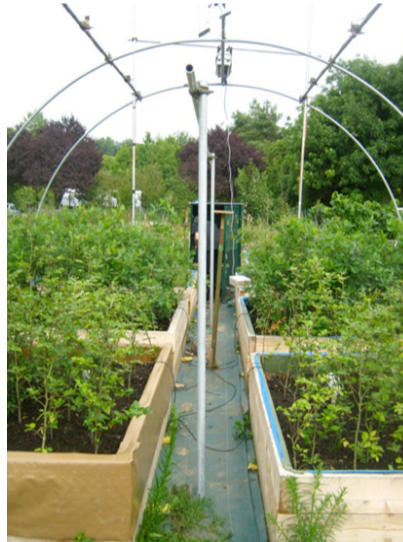
Fig. 14 : Le système expérimentale constitué de 3 espèces (chêne pédonculé, hêtre et pin sylvestre) chacune étant répartie dans 2 bacs distincts afin d'introduire un contraste de contenu en eau dans au sein de chaque espèce.
