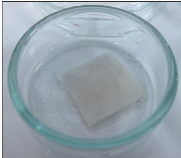
Figure 23 : Echantillon de matériau électrospinné (PVA avec nanoparticules d'HA de 20nm) mis en place dans une boîte de Pétri avec revêtement.
