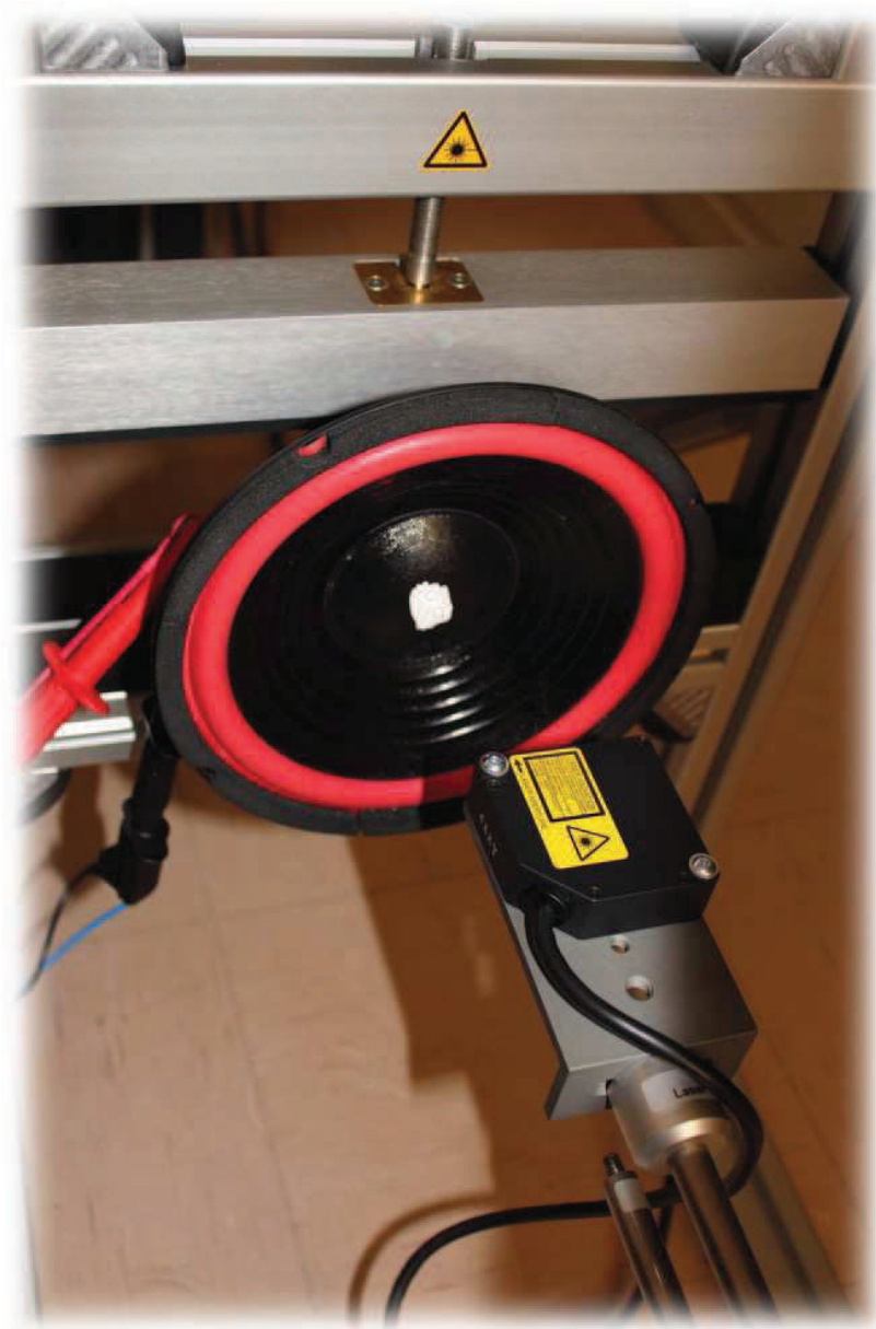
Planche II : Caractérisation d'un haut-parleur générique (Banc Klippel®)
