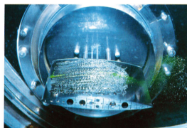
FIGURE 1.3: cavitation à poche
