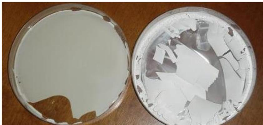
**Figure 12.** Films de mélange  $\text{TiO}_2$ /PEBD ; les dilutions de  $\text{TiO}_2$  sont égales à 60% (à gauche) et 70% (à droite)
