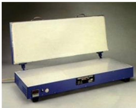
Figure 21. Glaceuse utilisée pour faire les prototypes base PEBD
