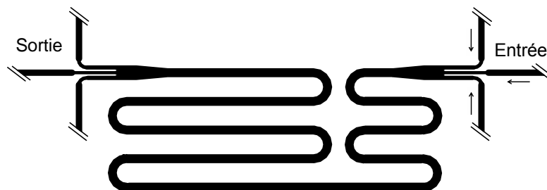
Figure II.7. Schéma du système microfluidique utilisé dans l'étude du mélangeur acoustique.
