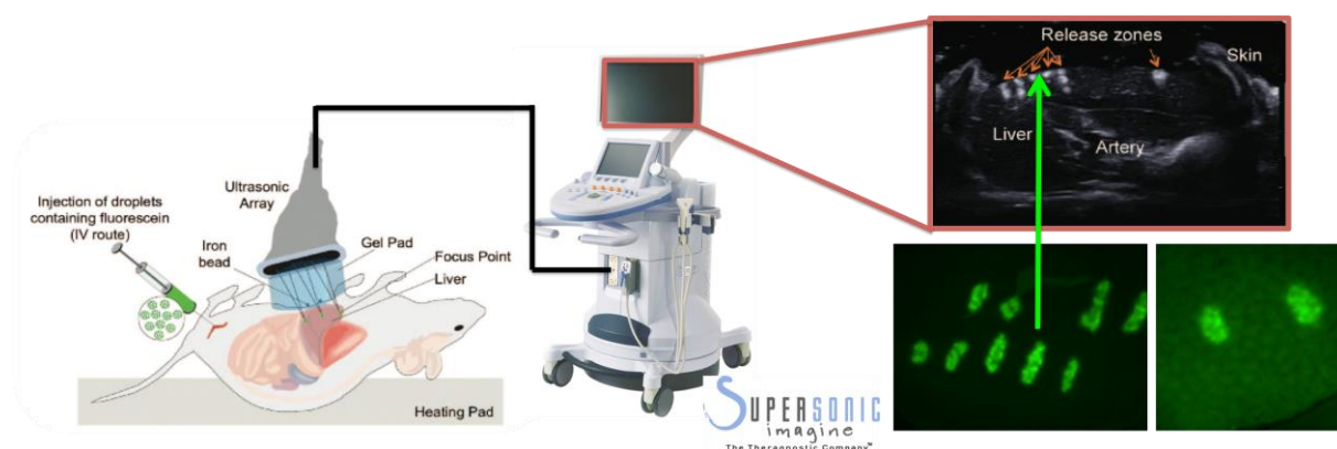
Figure I.9. Largage de microgouttes de PFC chez le rat à l'aide d'un échographe clinique : apparition de zones de largage sur l'image échographique (en haut) et sous lumière UV (en bas).
