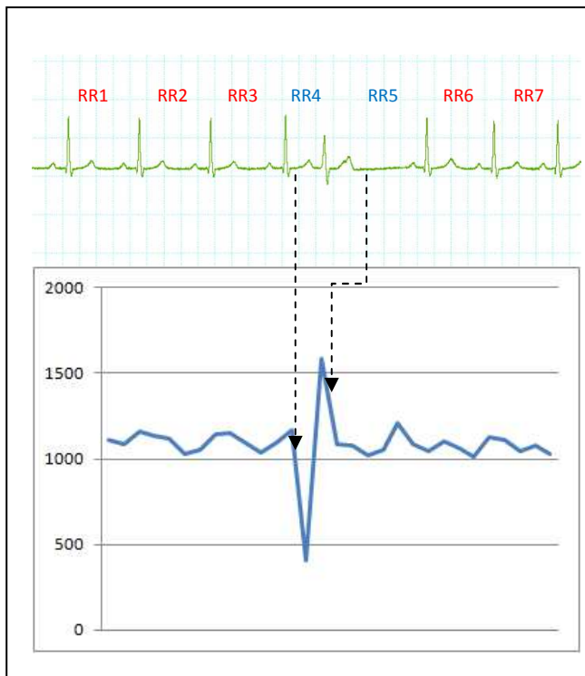
Figure 49. Exemple de tracé ECG avec extrasystole et impact sur le Périodogramme.
