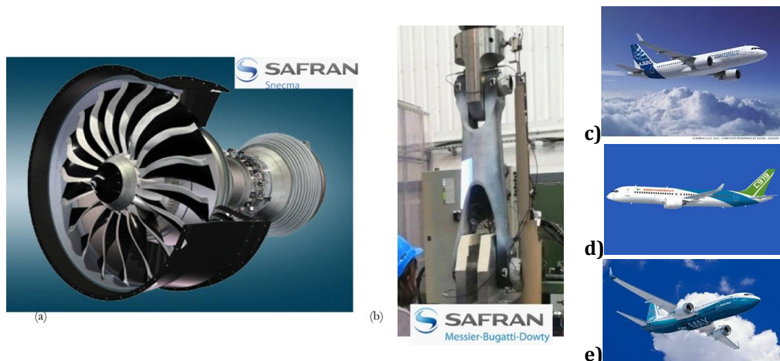
Figure 1 : a) moteur LEAP et b) essai sur contrefiche du train d'atterrissage (MBD), c) A320 neo Airbus, d) C919 Comac, e) 737 max Boeing
