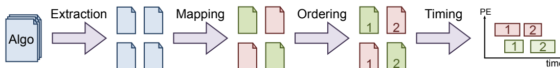
Figure A.2 – Ordonnancement Multiprocesseur d'une application sur une plateforme composée de deux processeurs
