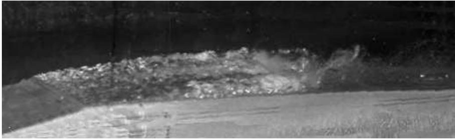
FIG. 6.1 – Photographie de la poche de cavitation attachée au venturi à 4°.
