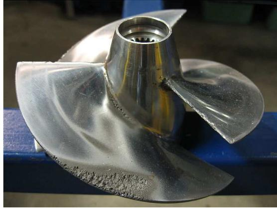
FIG. 1.11 – Erosion de cavitation sur les pales d'une hélice
