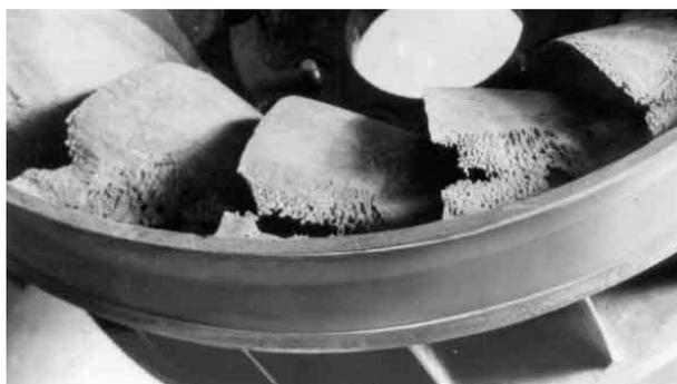
FIG. 1.18 – Erosion de cavitation sur une roue de turbine Francis
