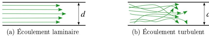
FIG. 3.2 – Régime de l'écoulement
