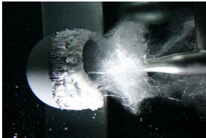
Cavitation instationnaire autour d'une sphère
