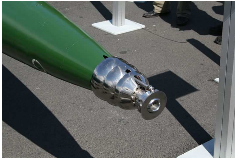
FIG. 1.15 – Nez de la torpille supercavitante russe
