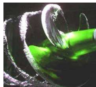
(b) Poches de cavitation attachées
