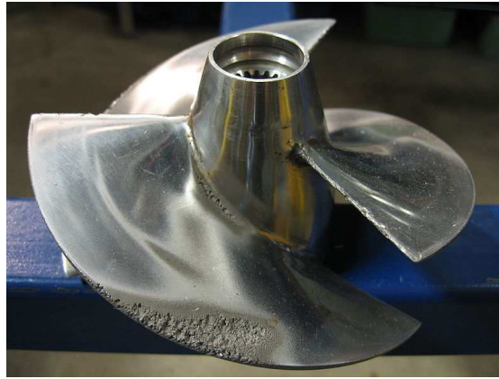
FIG. 1.11 – Erosion de cavitation sur les pales d'une hélice
