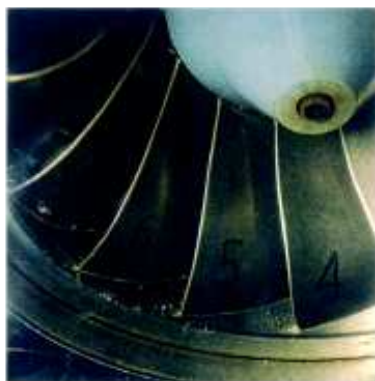
(a) Cavitation de sortie, du côté de la ceinture
