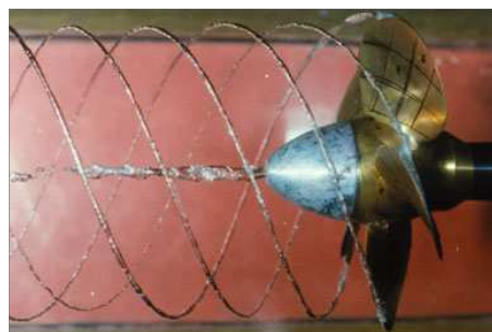
(a) Cavitation en bout de pales
