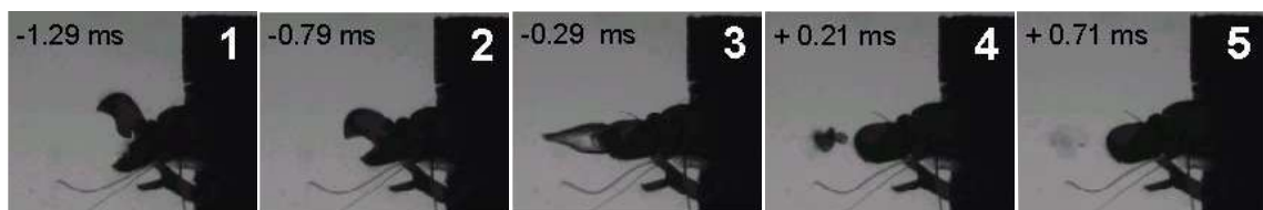
FIG. 1.23 – Séquence de fermeture de la pince avec création des bulles de vapeur à l'extrémité
