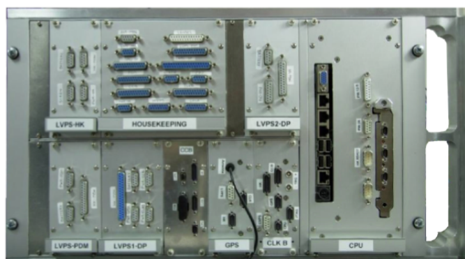
FIGURE 2.14 – Le Data Processor (DP) collecte et traite les données du PDM. Il gère le stockage, la télémétrie et le housekeeping[62].
