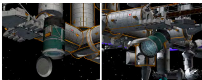
FIGURE 2.2 – Les deux modes de fonctionnement de JEM-EUSO : mode nadir (le télescope est vertical) et mode tilted (le télescope est incliné). [36]
