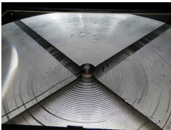
FIGURE 4.13 – La lentille L3 à la récupération. Seul le côté en contact avec l'eau a été mouillé. Aucune eau n'a pénétré dans le compartiment électronique.
