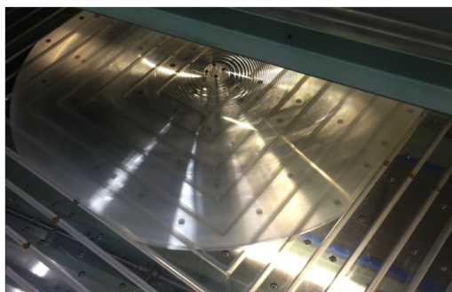
FIGURE 3.2 – Lentille de Fresnel en cours de fabrication, posée sur la machine, en attente du deuxième passage pour la taille de précision.
