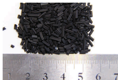
FIGURE II.1 – Photo du catalyseur « Octolyst 1001 ».
