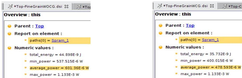
Figure 5-19: Courant de fuite avant et après insertion de la structure de gestion du power gating
