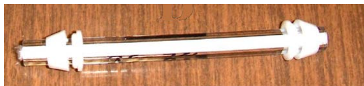
Figure 3.7 : Image d'une colonne chromatographique remplie de la silice pyrogénique calibrée à 400 \mu\text{m} .
