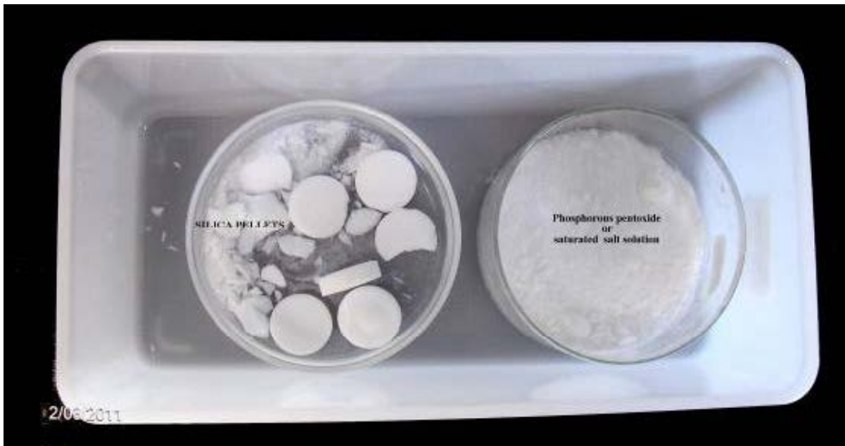
Figure 3.3: Séchage préalable des pastilles de silice pyrogénique en présence de P_2O_5 .
