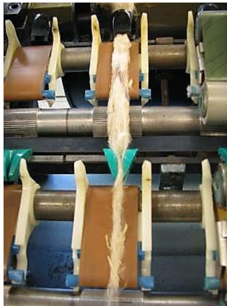
Figure 53. Passage sur continu à lanières du mélange coton-bagasse, 80 tex
