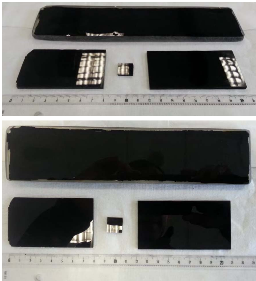
Figure 4.6 : gamme des différentes dimensions de composites « tapis de NTCs alignés / époxy » à l'état poli-miroir (reflet volontaire de la lumière) d'épaisseur homogène (allant de 2,0 à 5,0 mm) qu'il est possible d'obtenir par infusion : 15 x 15 mm, 80 x 50 mm, 220 x 50 mm ;
