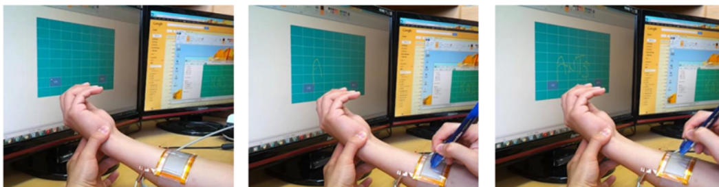
FIGURE 1.34 – Écran tactile flexible grande surface, fonctionnant sur une surface non plane. Les lettres "ANTS" sont écrites sur le panneau tactile et affichées sur l'écran d'ordinateur [112].
