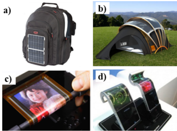
FIGURE 1 – Nouvelles applications optoélectroniques flexibles : a) cellules photovoltaïques conformables intégrées à a) un sac à dos, b) une tente ; c) écrans enroulables ; d) téléphones portables à écran souple.
