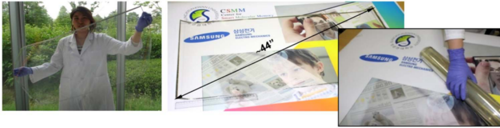
FIGURE 1.11 – Électrode transparente grande surface ( 100 \times 50 \text{ cm}^2 ) réalisée par dépôt par spray. En encart à droite : une photographie d'un rouleau de film PET couvert par un hybride oxyde de graphène - Ag NF [35].
