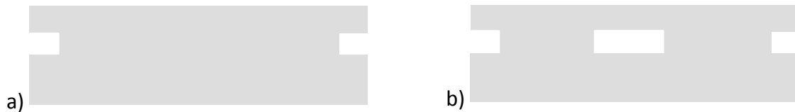
Figure 3.16 : Vue schématique a) du démonstrateur équipé avec des chanfreins et b) du démonstrateur équipé d'une cavité et de chanfreins.
