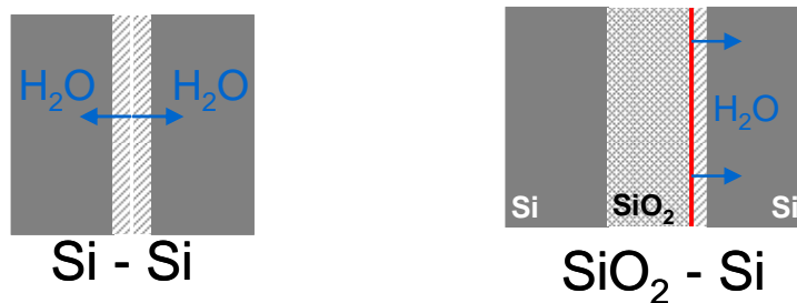
Figure 5.1 : Schématisation de la diffusion de l'eau piégée à l'interface dans le cas d'un collage Si-Si et SiO 2 -Si [5.4].
