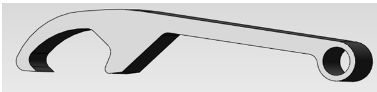
FIGURE C.1 – Décapsuleur en Aluminium fabriqué par découpe jet d'eau d'une plaque de 8 mm d'épaisseur
