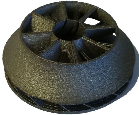
FIGURE 2.5 – Turbine carénée réalisée par notre moyen EBM
