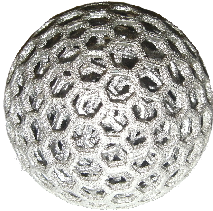
FIGURE 2.8 – Sept sphères évidées et imbriquées les unes dans les autres réalisées par notre moyen EBM
