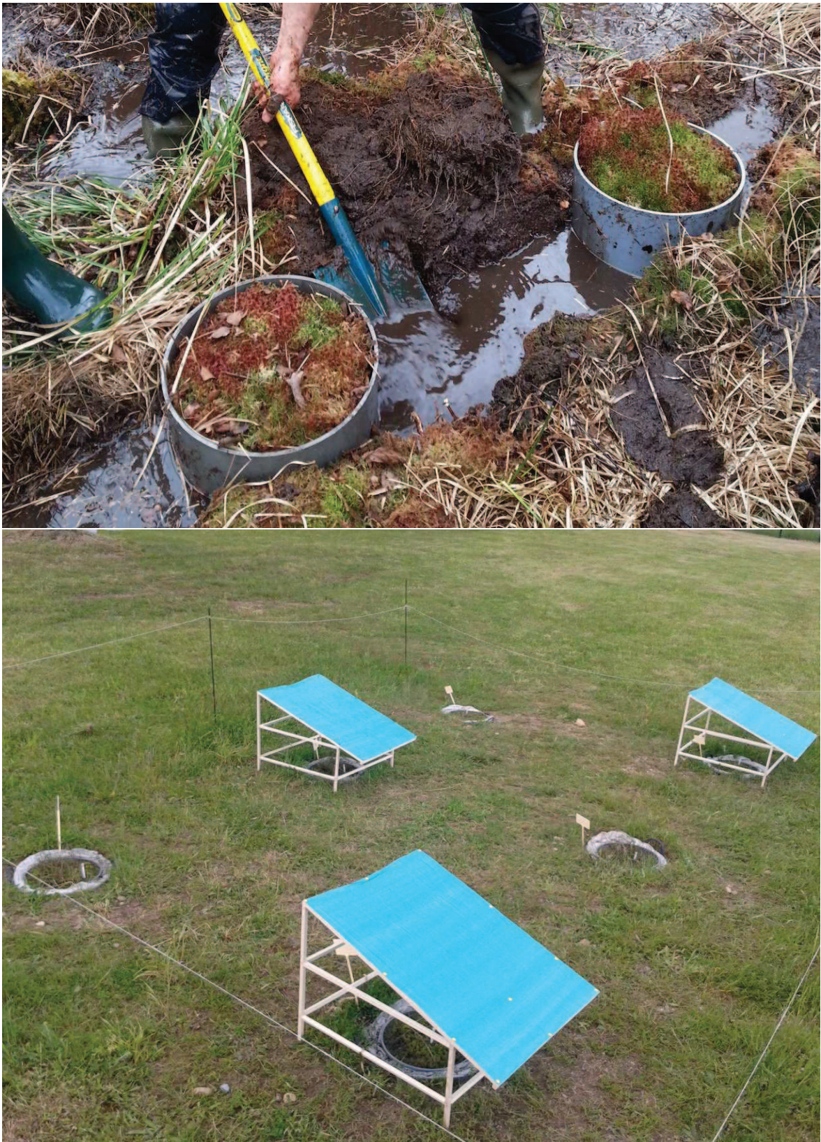
FIGURE 4.1 – Prélèvement des mésocosmes sur la tourbière de La Guette (en haut). Mésocosmes installés près du laboratoire : 6 témoins et 6 traités, avec des dispositifs pour intercepter la pluie (en bas).
