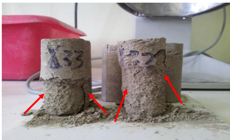
Figure IV-11 : Éprouvettes traitées à 6% de chaux après 8 cycles de mouillage-séchage
