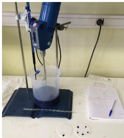
Figure II-6 : Système d'essai au bleu méthylène
