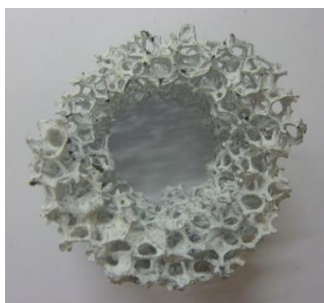
Figure 72 : Mousse mousses de \beta -SiC percée après imprégnation de \text{TiO}_2 et calcination à 380^\circ\text{C} .
