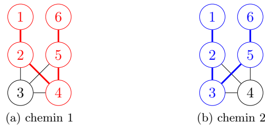
FIGURE 1.2 – Exemples de chemins de longueur 4 entre les nœuds 1 et 6 du graphe (a) de la figure 1.1.
