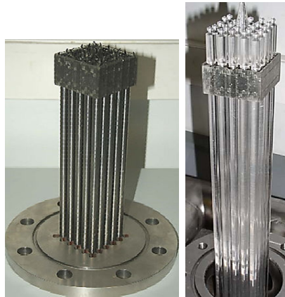
(a) Crayons en acier inoxydable en amont de la grille de mélange (b) Crayons en plexiglass en aval de la grille de mélange et maintenus par une grille en inox
