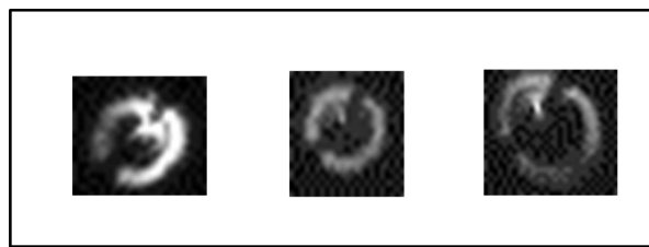
(b) Distorsion de la forme apparente des particules sur l'image pour des tailles apparentes inférieures à 20 pixels.
