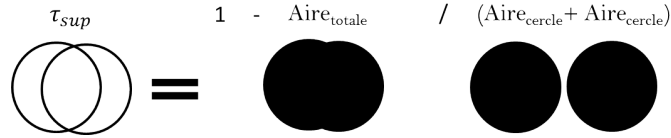
FIGURE 2.17 – Schématisation de l'obtention de \tau_{sup} pour deux particules partiellement superposées.
