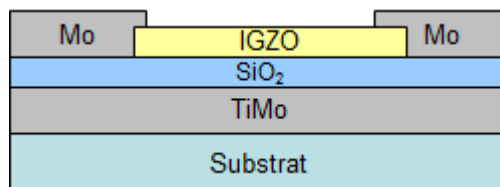
Figure 3-9 : Gravure des électrodes de source et drain
