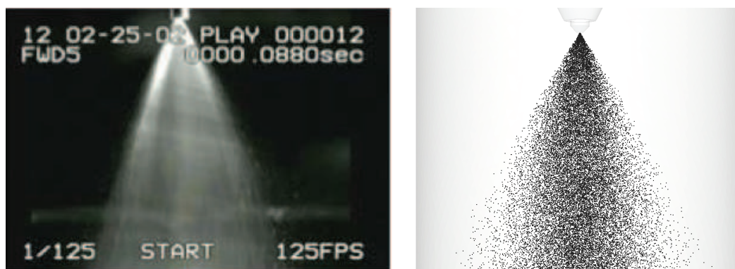
FIGURE 5.18 – Photographie du spray (gauche), et ensemble des particules dans la simulation Lagrangienne (droite).
