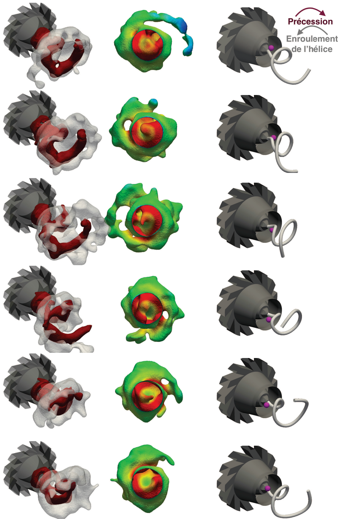
FIGURE 5.44 – Iso-surfaces de levelset \Phi_T = 0.5 et \Phi_Q = 0.5 (gauche), iso-surface de levelset \Phi_T = 0.5 vue du fond de chambre, coloriée par les RMS de vitesse (milieu), et représentation schématique de l'enroulement du PVC et de la position du point d'accrochage de la flamme (droite). Les images sont prises à des temps successifs répartis sur un tour de précession du PVC.
