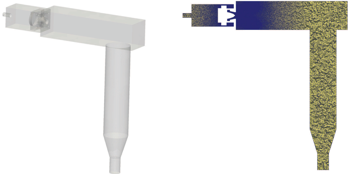
FIGURE 5.6 – Domaine de calcul modélisé dans les simulations du banc MERCATO (gauche), et coupe médiane du maillage grossier (droite).
