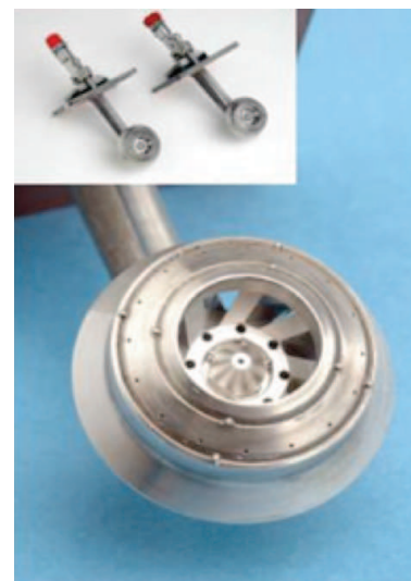
FIGURE 2.9 – Photographie d'un système d'injection multi-point (SNECMA) : vue globale et vue rapprochée [76]
