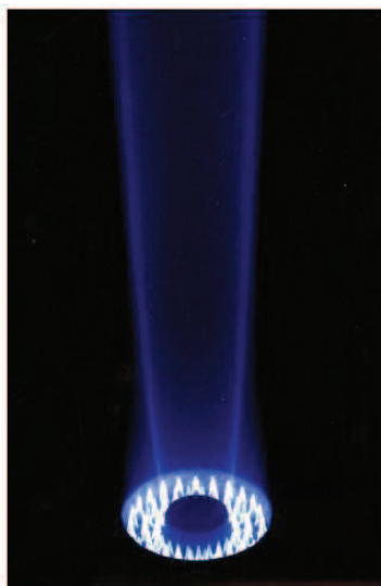
FIGURE 2.10 – Photographie de la flamme dite de Sandia D. Le jet central (25% de méthane et 75% d'air en volume) est entouré de 72 flammes pilotes pauvres (mélange de C_2H_2 , H_2 , air, CO_2 et N_2 ). [1]
