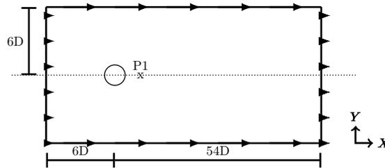
FIGURE 8.1 – Domaine fluide ( $\Omega$ ) et les contours ( $\Gamma$ ) pour le cas de l'écoulement autour du cylindre.
