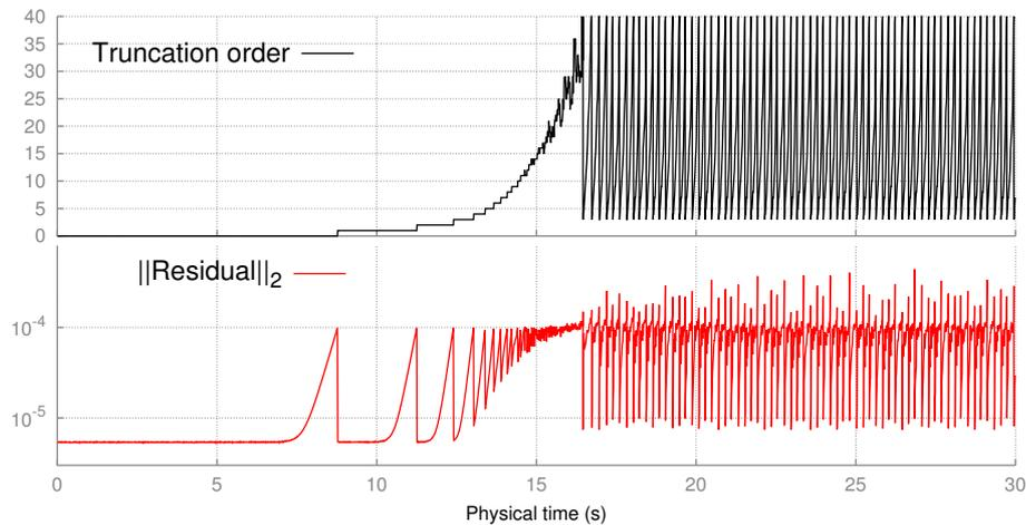
FIGURE 8.12 – L'ordre de troncature et la norme du vecteur résidu sont tracés pour l'ensemble du domaine temporel avec l'utilisation des paramètres suivants : tHP adaptative,  $N_{MAX} = 40$ ,  $\eta = 10^{-4}$ , maillage M2, 3000 pas de temps.
