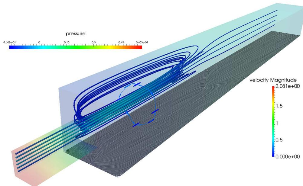
FIGURE 8.18 – Écoulement tridimensionnel pour  $Re = 208$ . Les lignes de courant révèlent la structure des centres et foyers sur une boucle fermée dans une même zone de recirculation. Le frottement pariétal est affiché pour une paroi, identique aux autres par symétrie. Le champ de pression est affiché en volume et les lignes de courant sont liées au champ de vitesse. Obtenu avec ELMER + MAN.
