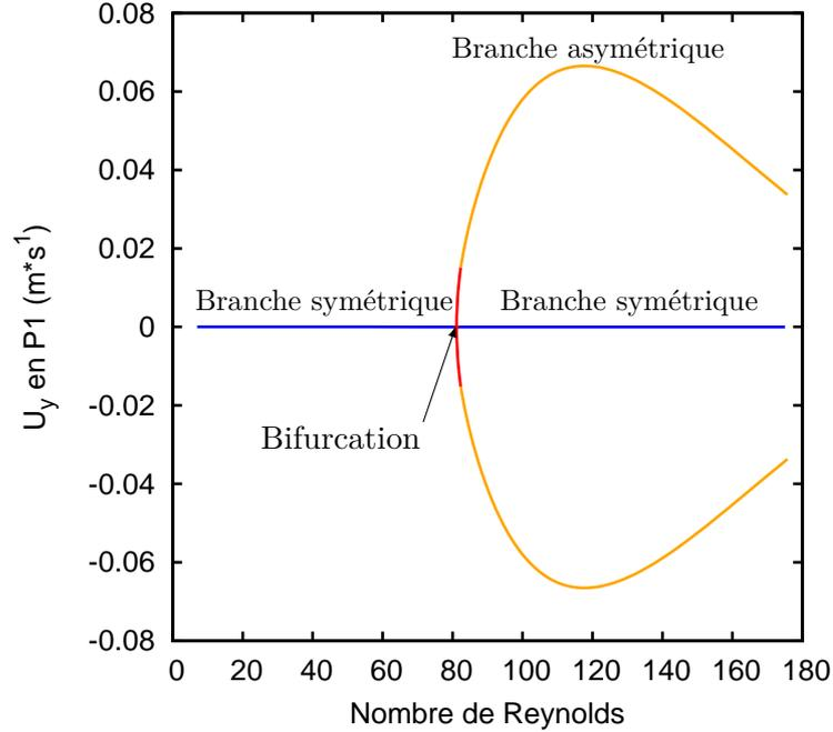
FIGURE 7.13 – Diagramme de bifurcation pour le cas  $E=3$ . En rouge les morceaux de branche obtenus avec un pas MAN en partant du point singulier. ELMER + MAN Q4-96k  $N = 30, \eta = 10^{-14}$ .
