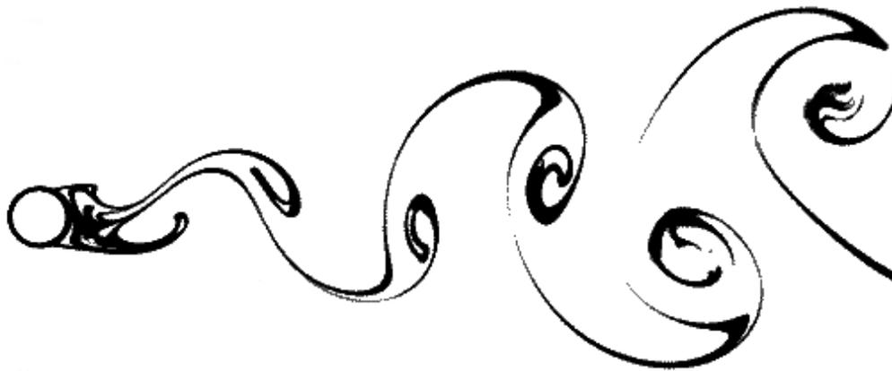
FIGURE 6 – Instabilité de Hopf de l’écoulement autour d’un cylindre fixe. D’après un cliché Sadatoshi Taneda (Université de Kyushu) extrait de [Van Dyke, 1982]
