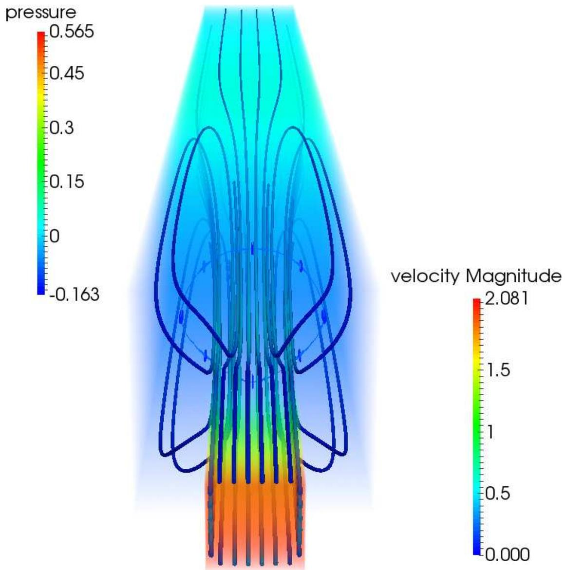
FIGURE 8.19 – Écoulement tridimensionnel pour  $Re = 208$ . Les lignes de courant révèlent la structure des centres et foyers sur une boucle fermée dans une même zone de recirculation. Le champ de pression est affiché en volume et les lignes de courant sont liées au champ de vitesse. Obtenu avec ELMER + MAN.
