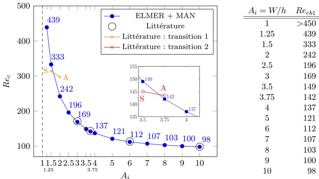
FIGURE 7.37 & TABLE 7.9 – Nombres de Reynolds critiques concernant la première bifurcation primaire pour différents ratios d'aspect  $A_i$  calculés avec ELMER couplé à la MAN. Les références sont entourées en cercle noir et les transitions d'écoulement symétrique (S) à anti-symétrique (A) sont tracées en couleurs orange et rouge.
