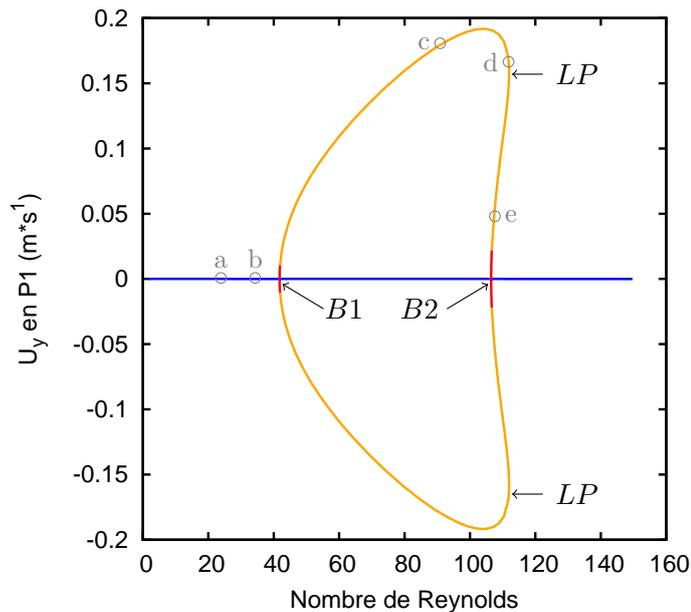
FIGURE 7.20 – Diagramme de bifurcation pour le cas de l'expansion-contraction  $E = 3$   $A=8/3$ . Les points solutions notés de (a) à (e) sont utilisés pour la discussion sur l'analyse des termes de séries.
