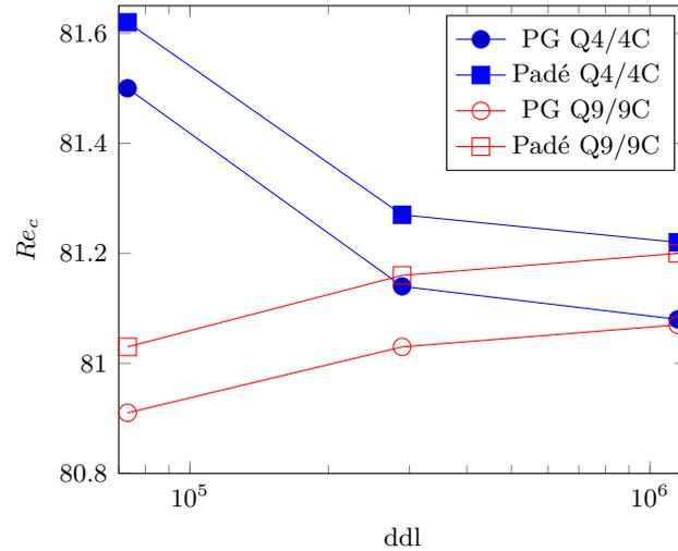
FIGURE 7.11 – Évolution du nombre de Reynolds critique en fonction du nombre de degrés de liberté pour deux types d'éléments finis. Cas de l'expansion soudaine  $E = 3$  avec les paramètres MAN  $N = 30, \eta = 10^{-14}$ .
