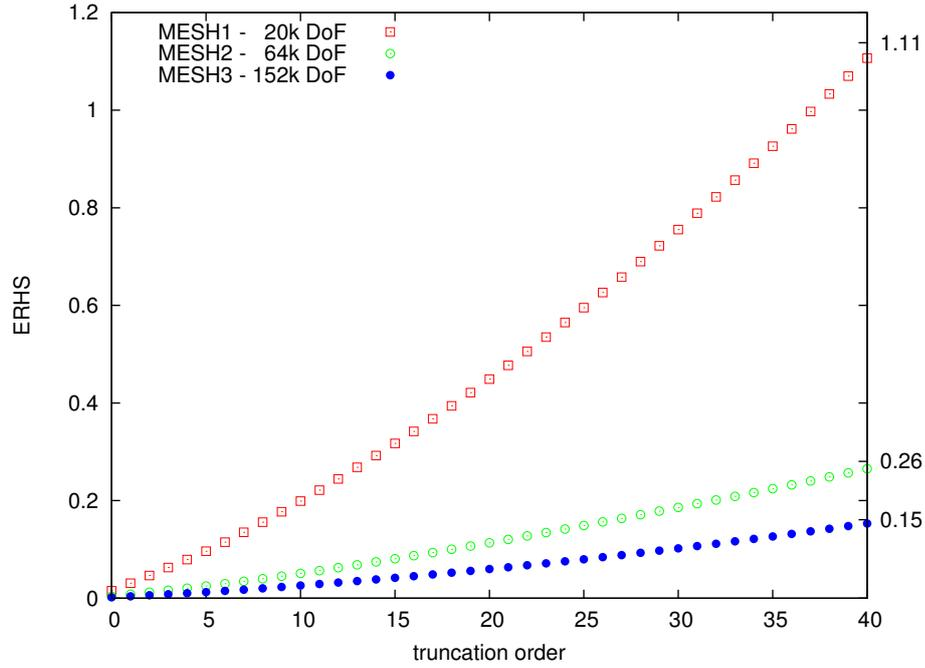
FIGURE 8.9 – Ratio ERHS nécessaire à l’assemblage des vecteurs  $\mathbf{FQ}_k$  (seconds membres MAN) en fonction de l’ordre de troncature de la représentation polynomiale pour trois maillages.
