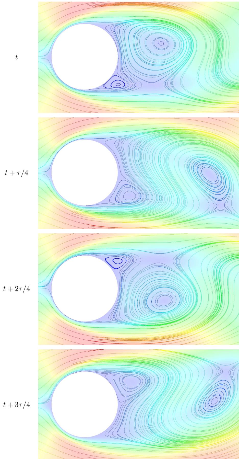
FIGURE 8.5 – Lignes de courant en vitesse pour une zone proche du cylindre. Une période  $\tau$  du cycle limite est découpée en 4 pas de temps de même taille. Méthode HPT adaptative,  $NMAX = 30$ ,  $\eta = 10^{-4}$ , maillage M3.
