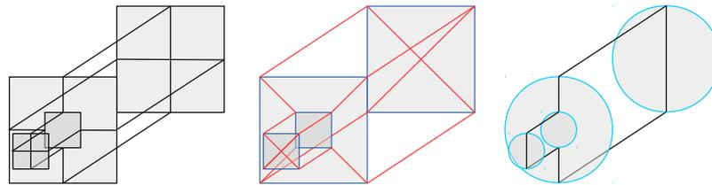
FIGURE 8.17 – Expansion soudaine avec deux groupes de 2 plans de symétrie de type  $\mathbb{Z}_2$  donnant un groupe de symétrie diédral  $\mathbb{D}_4$ , et à droite une expansion soudaine présentant une symétrie de rotation  $\mathbf{O}(2)$ .
