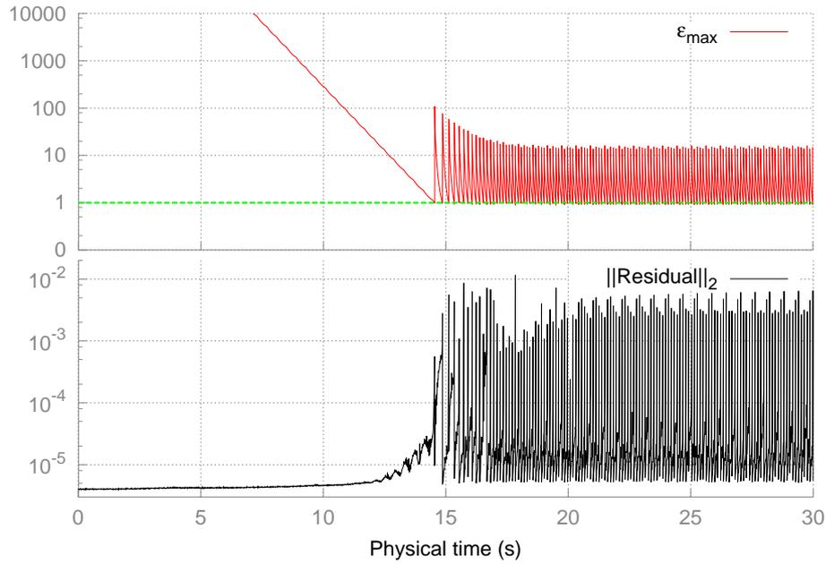
FIGURE 8.6 – Comportement de la méthode HPt utilisant la représentation polynomiale. La borne supérieure du domaine de validité  $[0, \varepsilon_{max}]$  des séries  $\{\mathbf{W}_{n+1}\}$  et la norme du résidu sont tracées en fonction du temps. Le maillage M1 est utilisé avec  $N = 30$ ,  $\eta = 10^{-6}$ .
