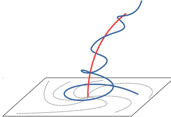
FIGURE 7.45 – Foyer sur une paroi signe d'une structure tourbillonnaire. La ligne de courant (bleu) s'enroule autour de la ligne de coeur du tourbillon (rouge) et les lignes de frottements sont en traits pointillés.
