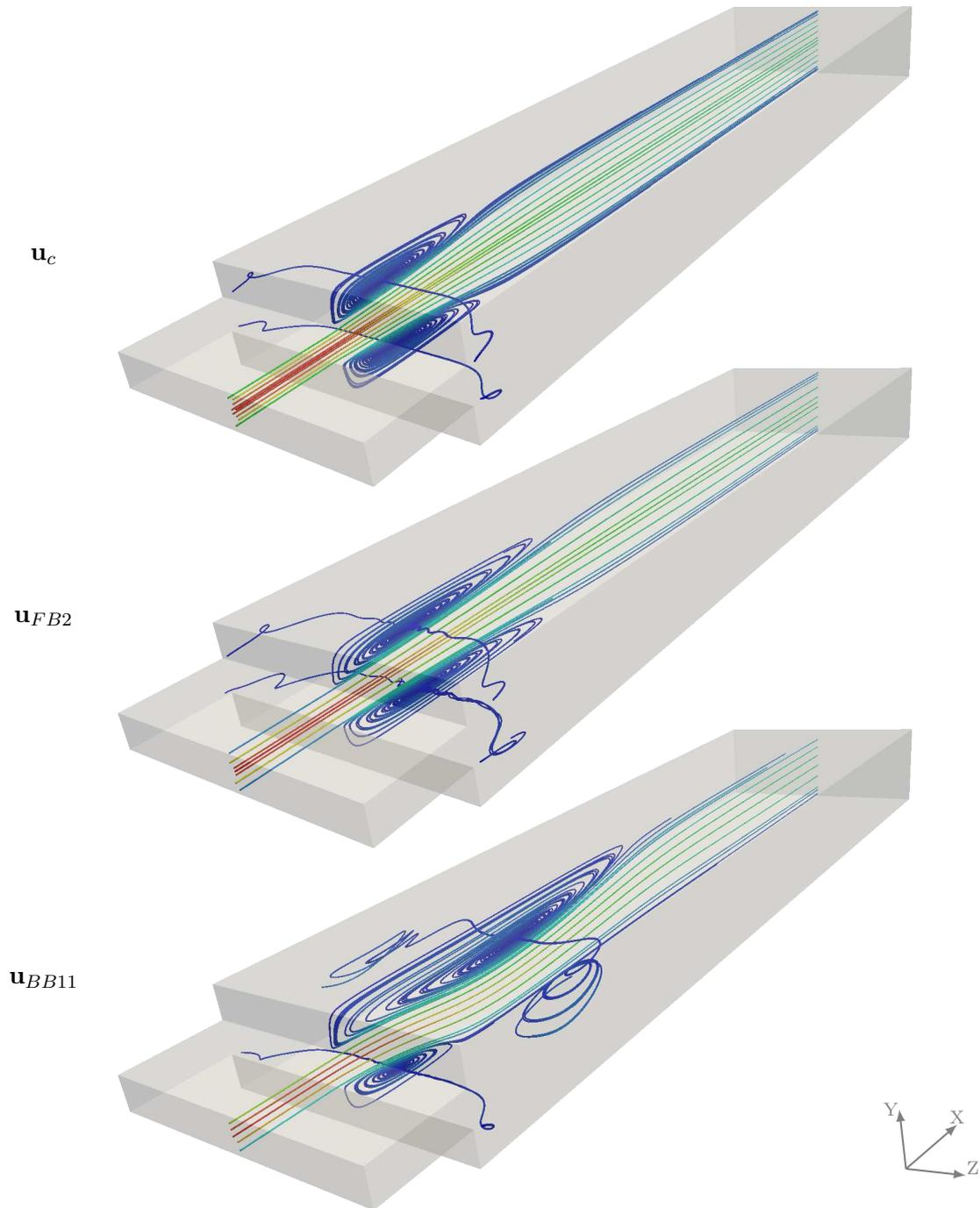
FIGURE 7.46 – Lignes de courant pour les écoulements tridimensionnels au point de bifurcation en  $Re_c = 103$  et de deux solutions, symétrique et anti-symétrique, en un même nombre de Reynolds  $Re=175$  pour le ratio  $A_i = 8$ .
