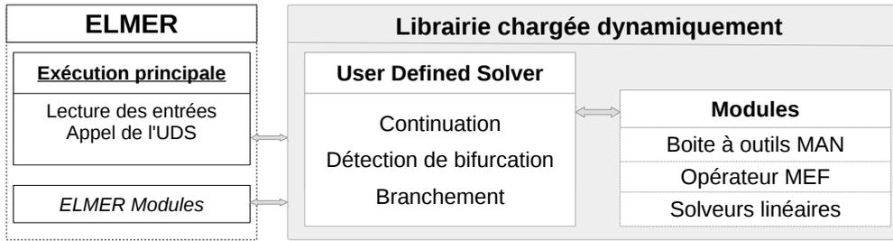
FIGURE 4.5 – Principe d'implémentation de techniques MAN dans ELMER.
