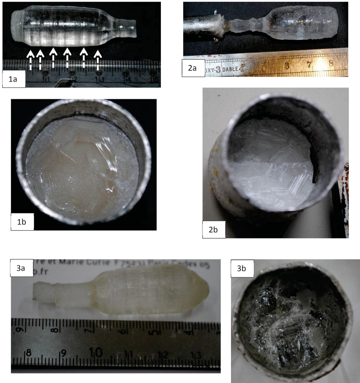
Figure 2.20 : Cristaux (a) et creusets après tirage (b) des monocristaux de composition souhaitée  $BaCa_{0,94}Yb_{0,03}Na_{0,03}BO_3F$  CZ01 (1), CZ02 (2) et CZ03 (3). Les flèches blanches en pointillés sur la figure 1a indiquent les plans de clivage pour le cristal CZ01.
