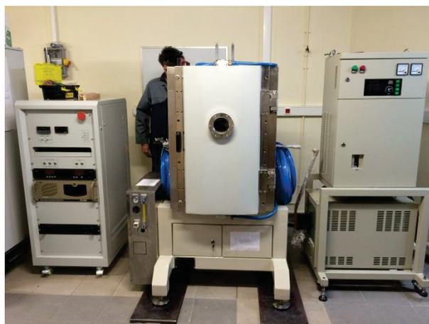
Figure 7.16 : Nouvelle machine de tirage Czochralski permettant la croissance de cristaux de 50mm de diamètre.
